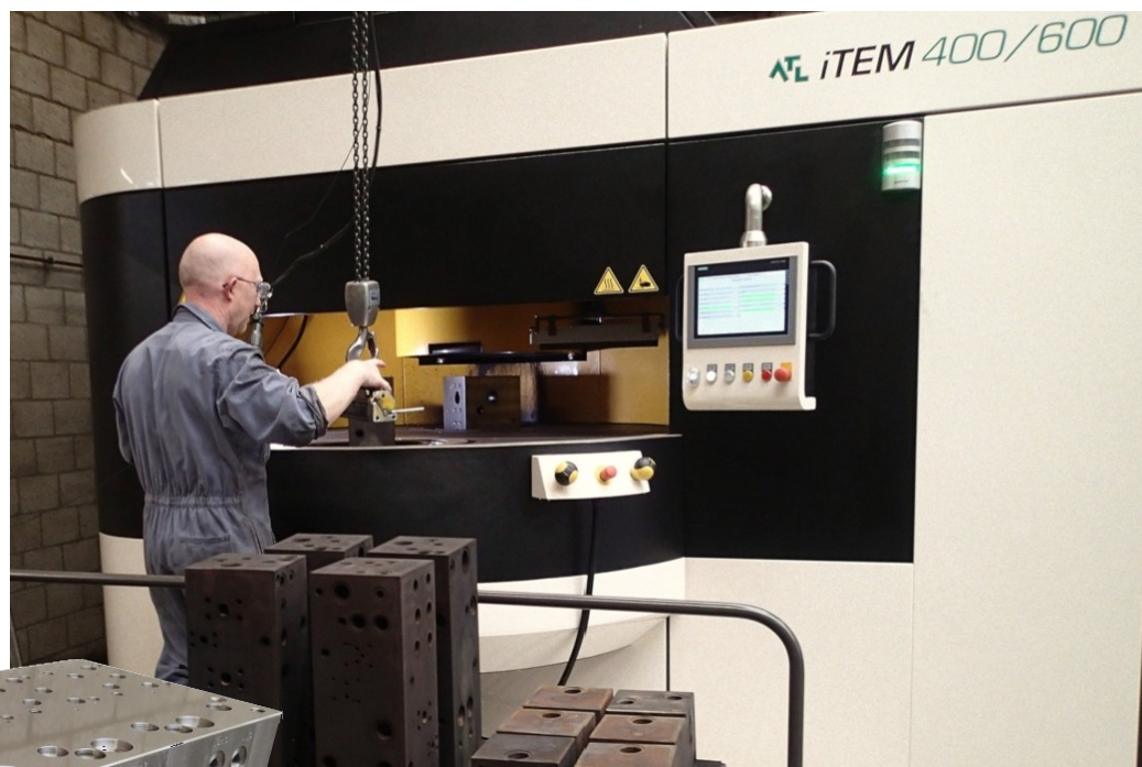
Nubé Hydraulics maakt complexe werkstukken met een groot aantal boringen. Voor de nabewerking investeerde het bedrijf in de grootste TEM-machine ter wereld
