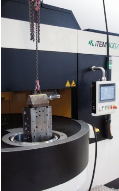
In de machine kunnen werkstukken met hoogte 600 mm en 400 mm diameter worden nabewerkt. Ze heeft een werkhogte van 1.380 mm en weegt 17 ton
